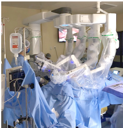
Figura 3. Posicionamento manual do boom (onde sai os braços do robô) em direção aos membros inferiores.
